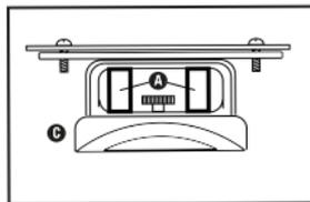
**SCHRITT 2** – Setzen Sie die Schüsselhalterung oben auf und stellen Sie sicher, dass die Löcher ausgerichtet sind, und Schrauben Sie sie wieder an.
