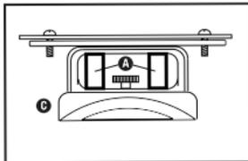
**VAIHE 2** – Aseta kulhon tuki laitteen päälle. Varmista, että reiät on kohdistettu oikein. Kiinnitä ruuvit uudelleen.
