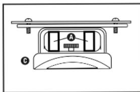
**TRIN 2** – Anbring skålfoden ovenpå, sørg for, at hullerne flugter, og skru skruerne i igen.
