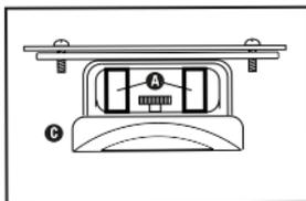
**PASO 2** – Coloque el soporte del recipiente en la parte superior, asegurándose de que los orificios estén alineados y vuelva a atornillarlo.
